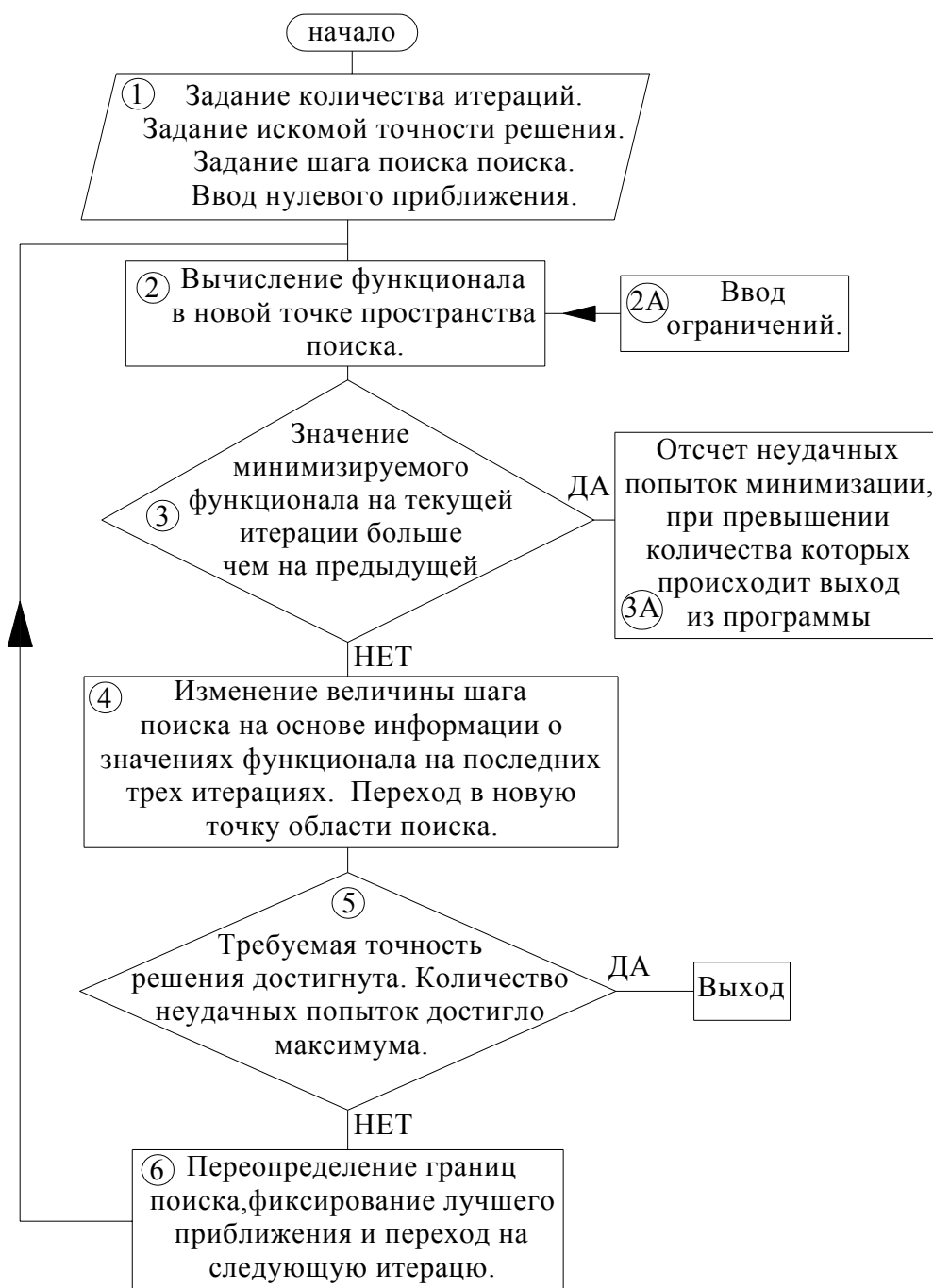
Рис. А1. Блок-схема алгоритма определения коэффициентов и степеней уравнения состояния методом случайного поиска с возвратом при неудачном шаге.
